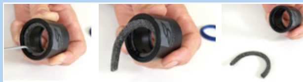
Obr. 122: Odstranění plstěného kroužku
