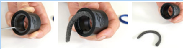
Obr. 157: Odstranění plstěného kroužku
