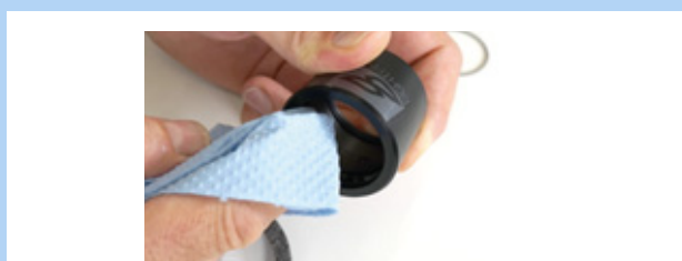
Obr. 123: Čištění vnějšího pouzdra
