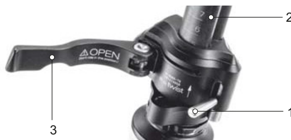
Obr. 86: Otevřená upínací páka rychloupínáku (3) představce (2) v provedení I s pojistnou pákou na představci (1)
