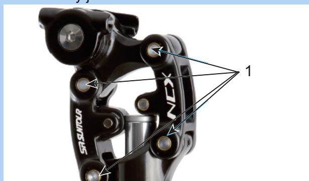
Obr. 110: Mazací body odpružené sedlovky Suntour SR
